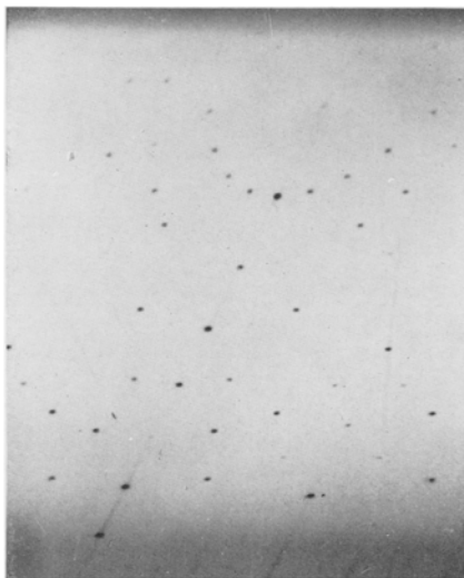
Abb. 1. \text{Tl}_3\text{HGe}_7\text{O}_{16} \cdot 4 \text{H}_2\text{O} : Ausschnitt einer Weißenberg -Äquatoraufnahme um [100] ; \text{CuK}_\alpha -Strahlung
